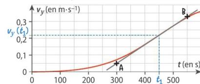
$$a_y(t_1) = \frac{v_{yB} - v_{yA}}{t_B - t_A} = \frac{0,33 - 0,05}{550 - 300} = 1,1 \times 10^{-3} \text{ m} \cdot \text{s}^{-2}$$
